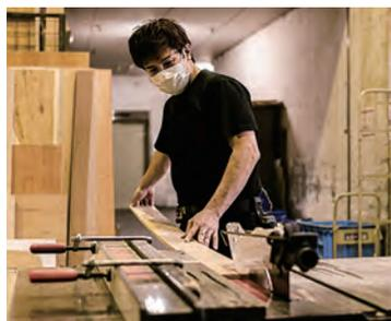
軸傾斜丸鋸盤で木材を裁断する。指を切ったり腰を痛めたりと、ケガにつきものの現場では、集中力が求められる
